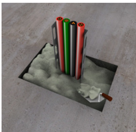
5. Zatvorite preostali otvor malterom PROMASTOP®-M. Uzmite u obzir sleganje maltera kod prodora većih dimenzija, što zahteva doradu kako bi se postigla tačna debljina ili visina.
